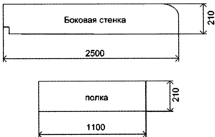
Рис. 61. Размеры заготовок стеллажа
