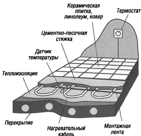
Рис. 117. Типичная конструкция электрического «теплого пола»
