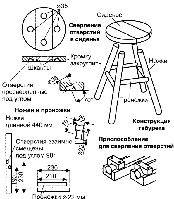
Рис. 53. Конструкция табурета
