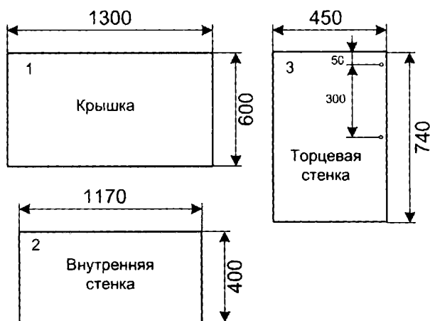
Рис. 56. Размеры деталей стола
